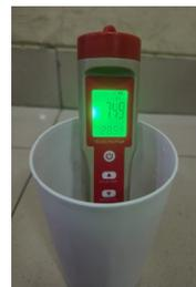
7. Angka yang tertera pada layar pH meter merupakan nilai pH dari sampel limbah cair yang telah diukur, yang menunjukkan tingkat keasaman atau kebasaan limbah cair hasil olahan IPAL. Nilai tersebut harus dicatat secara akurat pada formulir Swapantau Air Limbah STP (FRM.IKL.014 REV 01).
